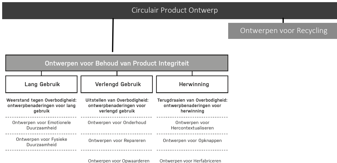
Figuur 1. Een typologie van ontwerpbenaderingen voor behoud van productintegriteit in een circulaire economie (den Hollander, 2018) [aangepast]
