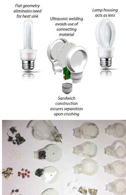
FIGUUR 32: PHILIPS SLIMSTYLE LED. BOVEN: ONTWERPKEUZES T.B.V. RECYCLEBAARHEID. ONDER: GESHREDDERDE SLIMSTYLE LEDS (BRON: PHILIPS)
